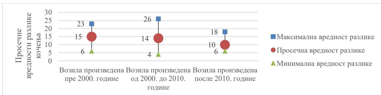
**Слика 9. Вредности одступања кочне сile точкова задње осовине за исправна возила**
