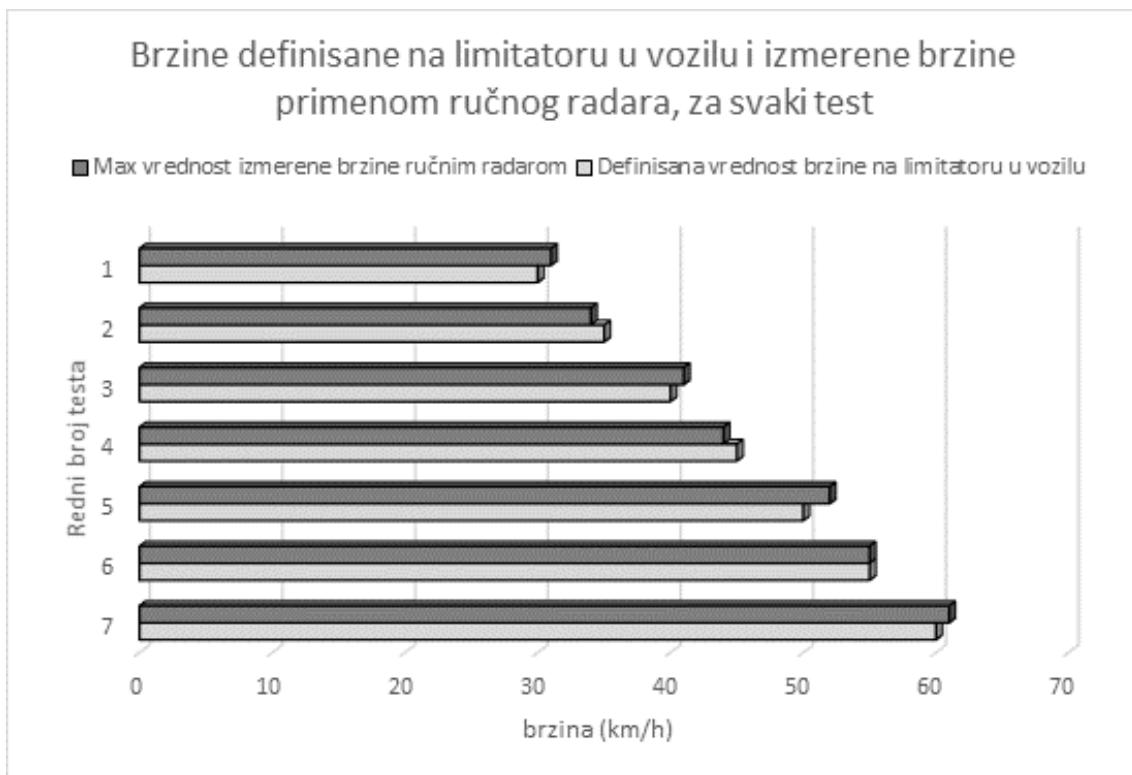
Slika 5. Odnos između ciljanih brzina definisanih limitatorom brzine u vozilu i brzina izmerenih ručnim radaram
