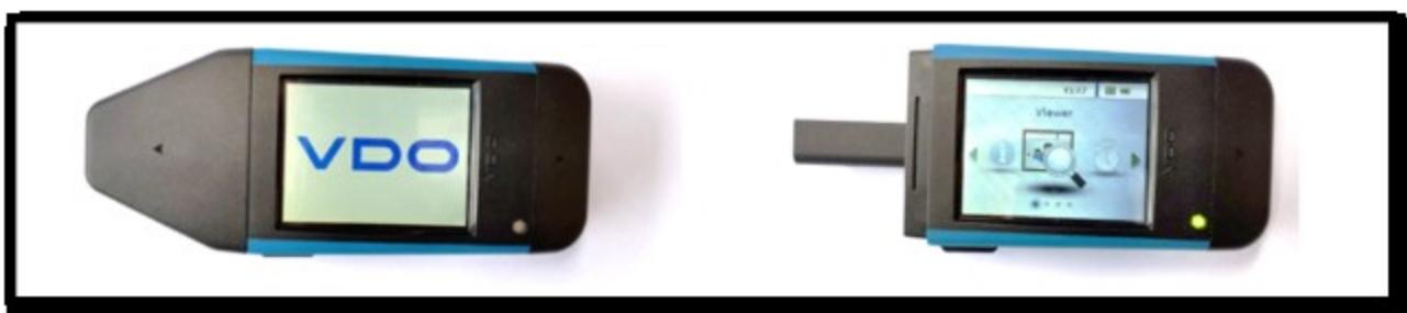
Слика 1. Изглед уређаја за ручно преузимање података са тахографа
