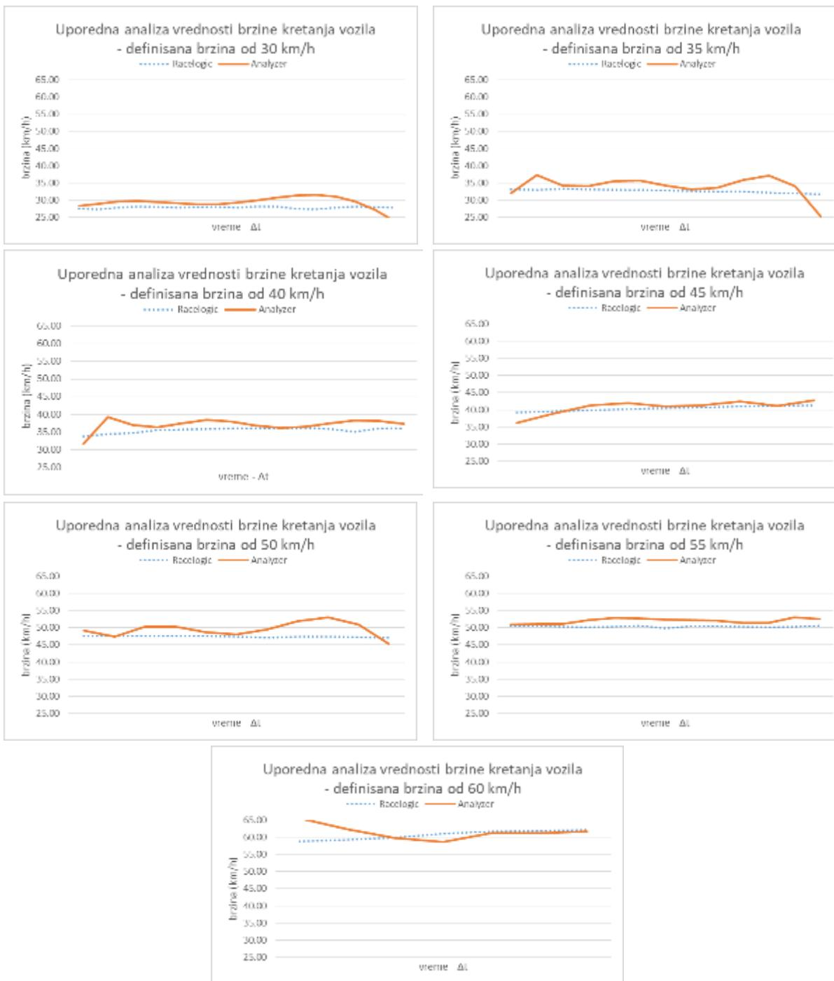
*Slika 7. Uporedni prikaz između ciljanih, izmerenih i proračunatih brzina kretanja vozila prilikom prolaska kroz virtualni poligon pri brzinama od 30-60 km/h*
