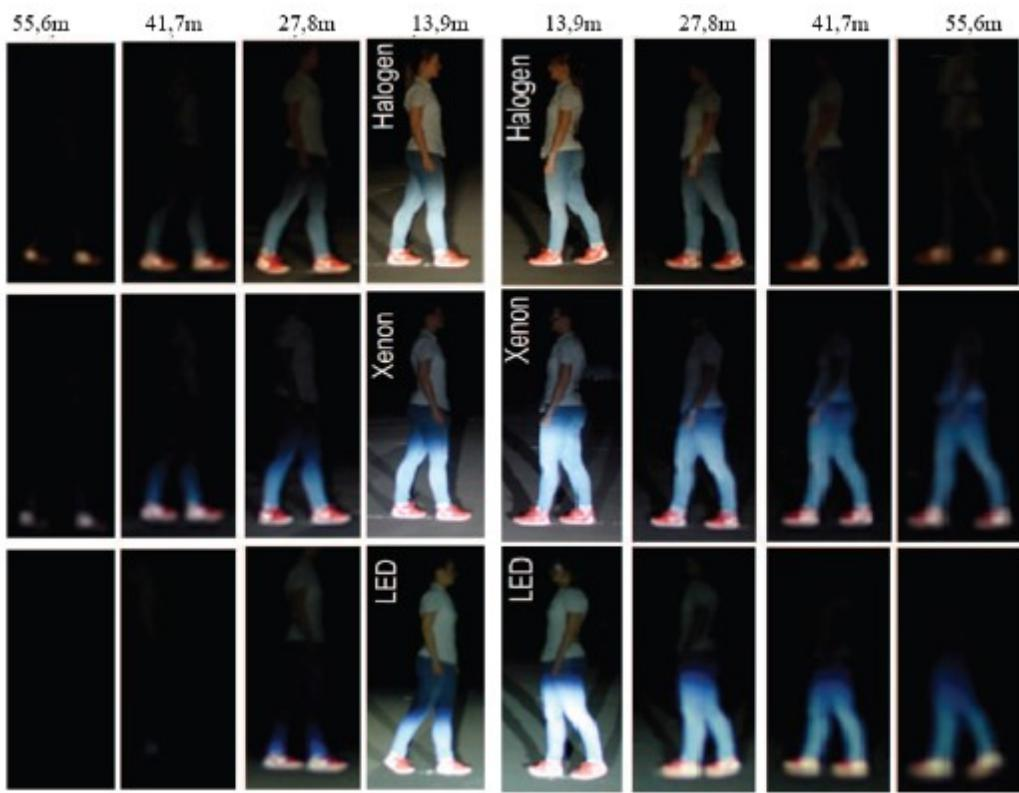
Slika br. 4 – Vidljivost pešaka na pojedinim udaljenostima
