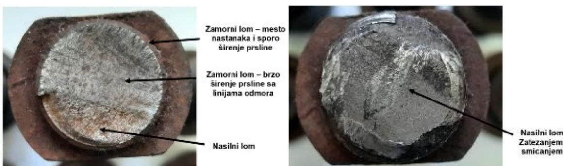
Slika 6. Levo: Zamorni lom vijka. Desno: Lom usled zatezanja/smicanja
