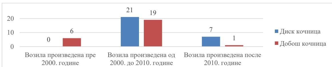
**Слика 5. Тип извршног органа кочења на задњој осовини у зависности од групе године производње возила**
