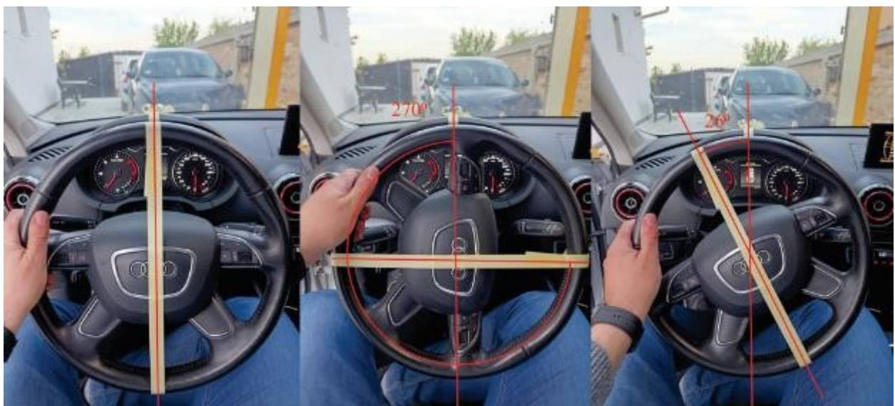
Slika 7. Primer definisanja ugla automatskog isključenja pokazivača pravca, za ugao zaokretaja točka upravljača od  $270^\circ$
