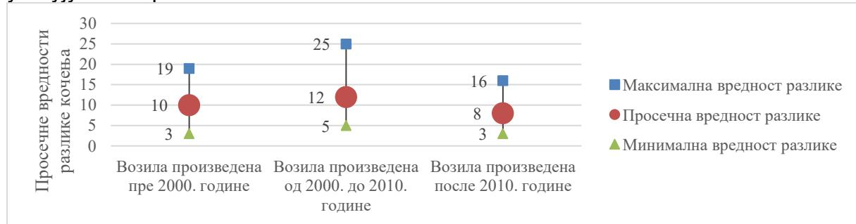
Слика 8. Вредности одступања кочне силе точкова предње осовине за исправна возила
