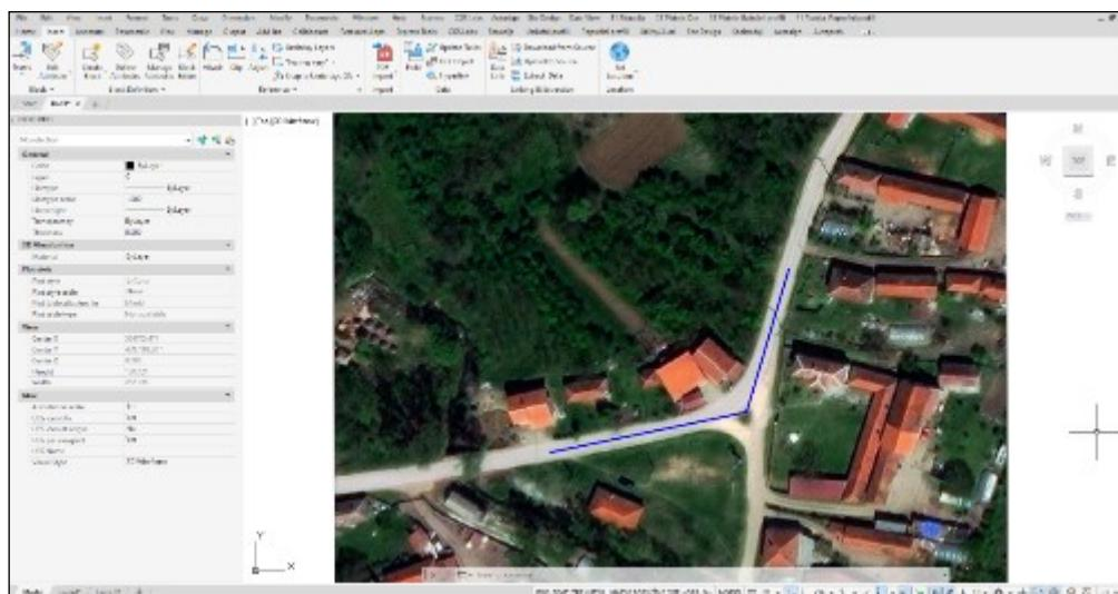
Slika 7. Crtanje tangentnog poligona.
