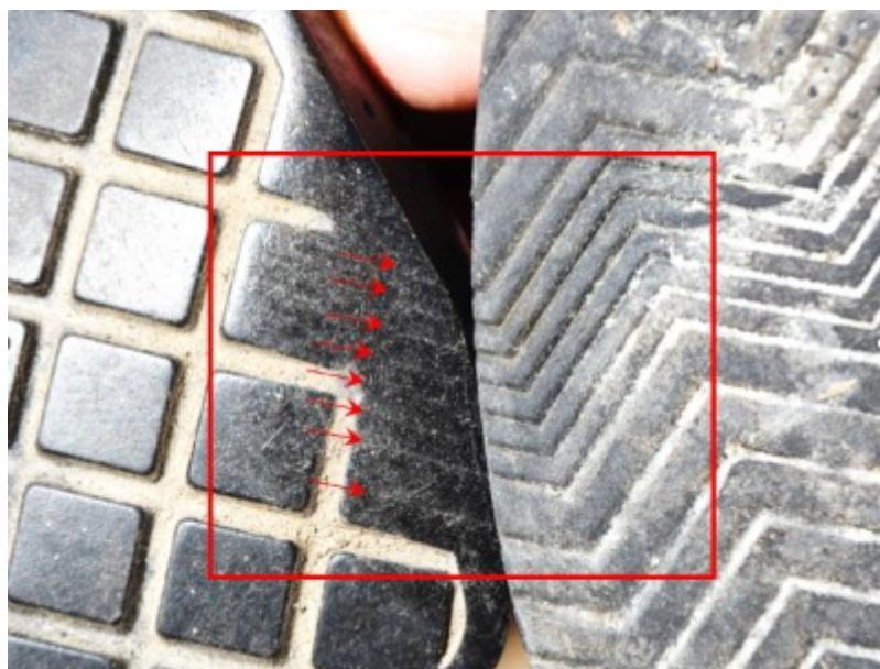
Slika 2. Otisak gazeće površine obuće na papučici kočnice
