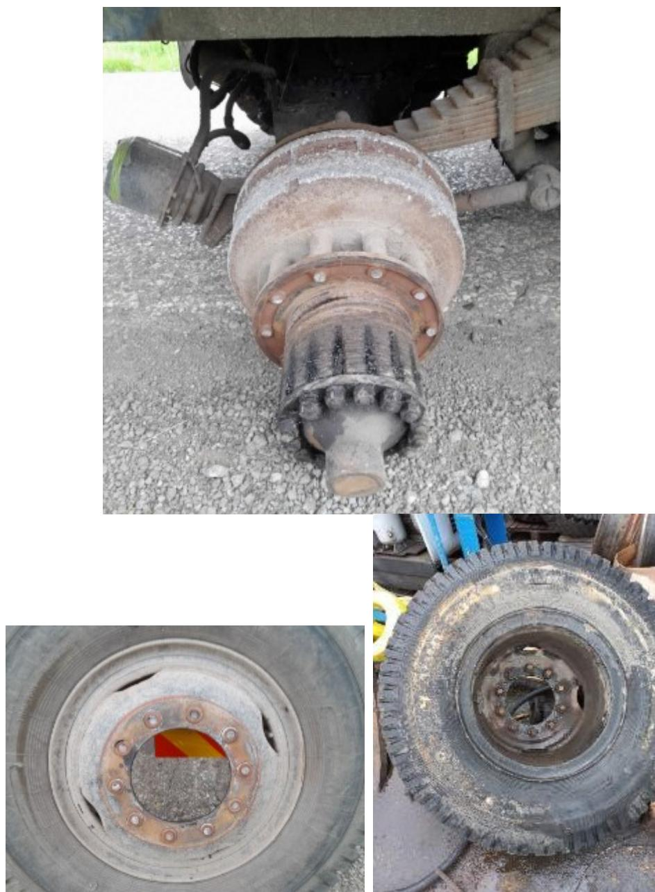
Slika 1: Zatečeno stanje osovine i točka (spoljašnjeg) nakon odvajanja
