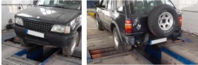
Слика 2. Провера исправности система за кочење на вальцима
