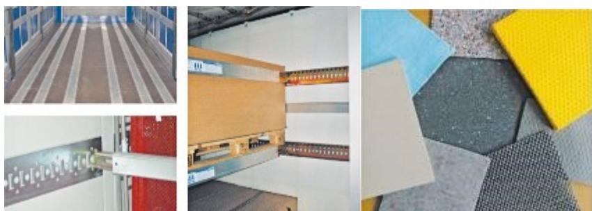
Pomoćna oprema, metalni profili koji se ugrađuju u karoseriju prikolice i materijali koji povećavaju koeficijent klizanja.
