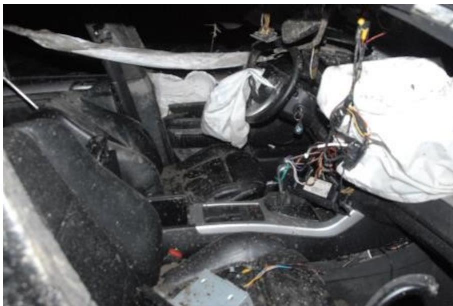
*Slika 9. Izgled unutrašnjosti vozila nakon sletanja sa kolovoza, sa aktiviranim vazdušnim jastucima*
