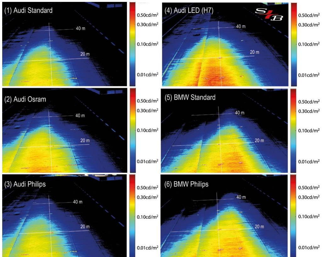
Slika br. 3 – Profili ispitivanih svetlosnih snopova
