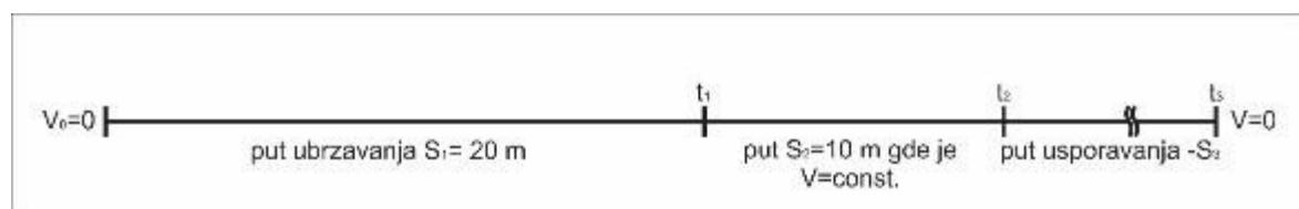
Slika 1. Prikaz poligona na kom je sprovedeno istraživanje
